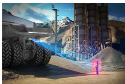
Epiroc erbjuder den högsta nivån av system för att undvika kollisioner för säkrare gruvdrift. Nivå 9. Om operatören inte agerar kommer systemet att ta över kontrollen och stoppa maskinen.
